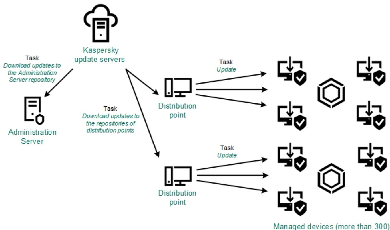
Обновление с использованием задачи *Загрузка обновлений в хранилище Сервера администрирования* и задачи *Загрузка обновлений в хранилища точек распространения*
