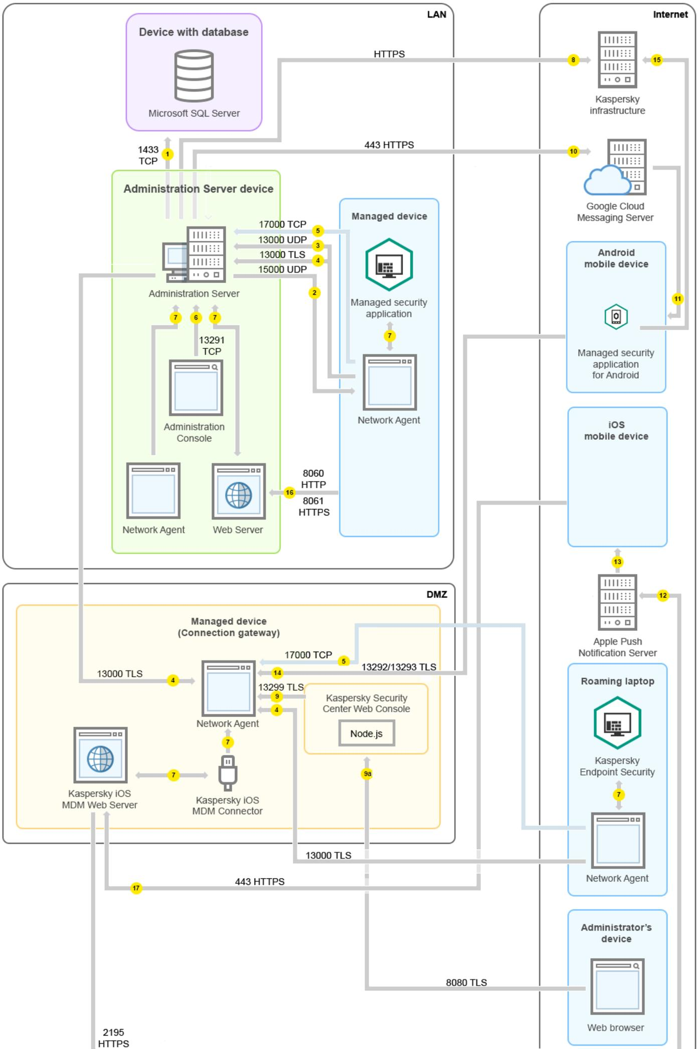
На этом рисунке управляемые устройства подключены к Серверу администрирования через шлюз соединений, который расположен в демилитаризованной зоне (DMZ). TMG или корпоративный сетевой экран не используются.
