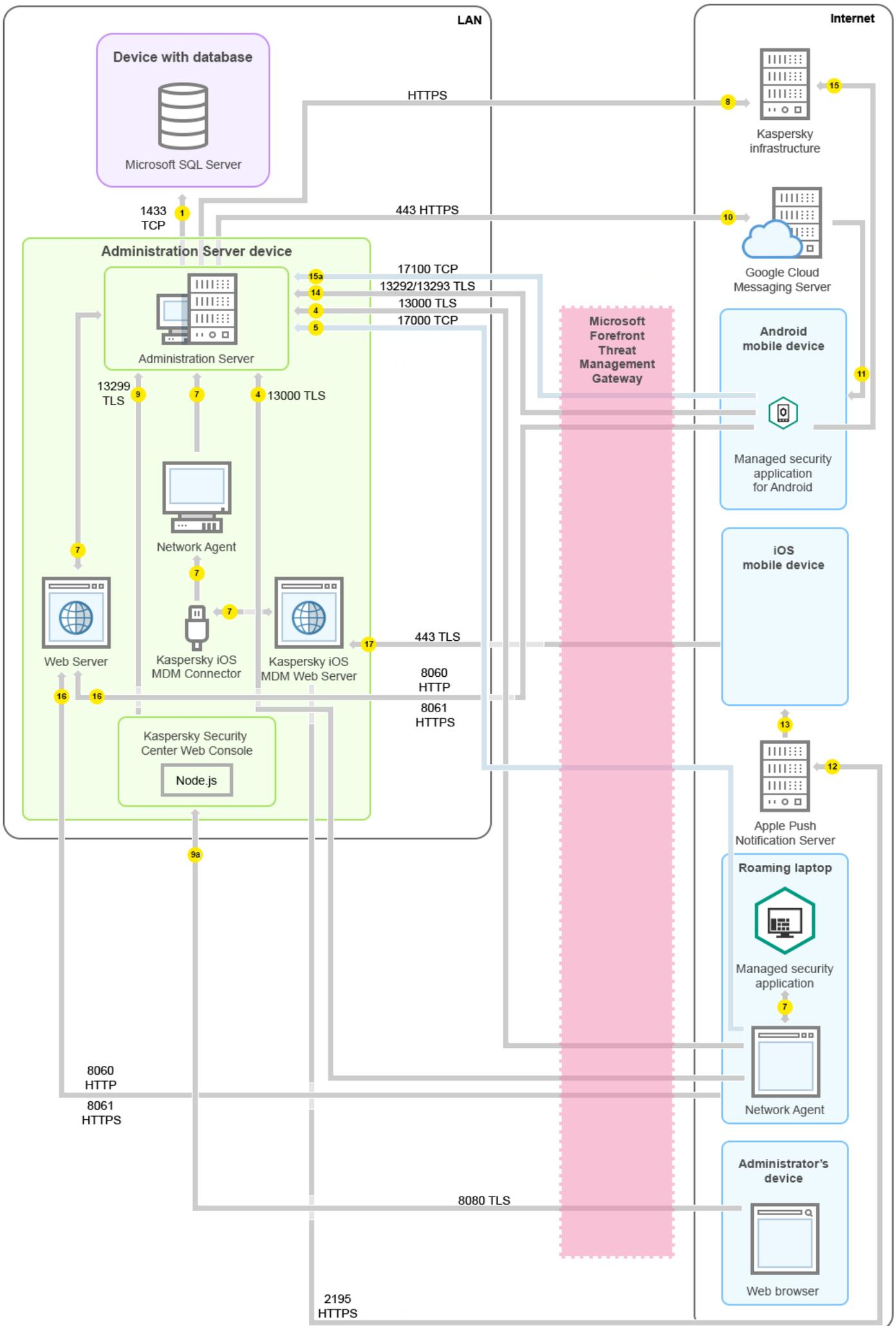
Эта схема развертывания рекомендуется, если вы не хотите, чтобы мобильные устройства подключались напрямую к Серверу администрирования, и не хотите назначать шлюз соединения в демилитаризованной зоне (DMZ).
