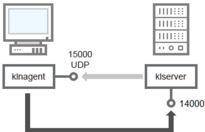
Сервер администрирования и клиентское устройство: управление программой безопасности, подключение через порт 14000 (низкая защита)
