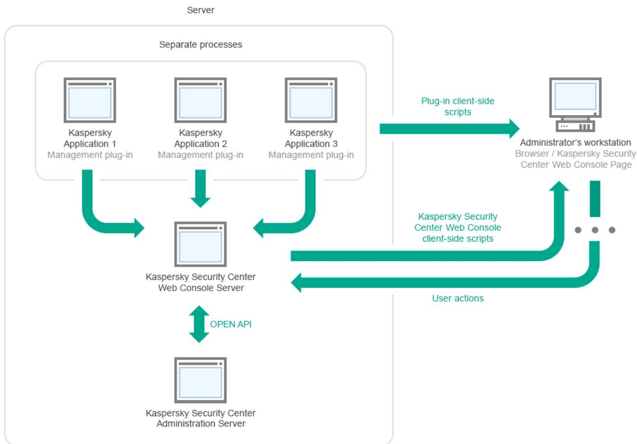
Схема развертывания Сервера администрирования Kaspersky Security Center и Kaspersky Security Center 13.2 Web Console
